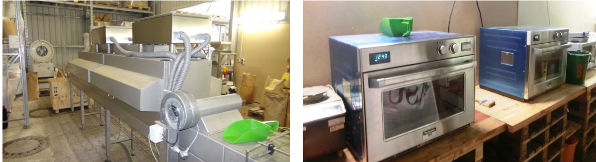
Abbildung 1: beide Mikrowellen im bildlichen Vergleich (links die ROSOMA-Maschine und rechts die neuen Industrie-Mikrowellen)
