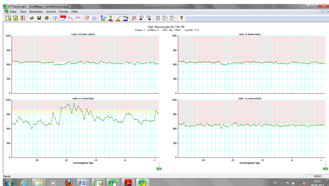
Abbildung 27: Grafik „Auffälliger_Viertelleitwert.dpg“ für ein Tier mit auffälligem Verlauf der Leitwertkurve auf dem linken Vorderviertel => Mastitiskontrolle nötig
