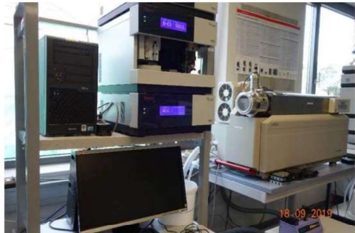
Abbildung 3.3.2: Hochleistungsflüssigchromatographie in Kopplung mit Tandemmassenspektrometrie (HPLC-MS/MS) Thermo Scientific Ultimate 3000 mit Sciex API 4000
