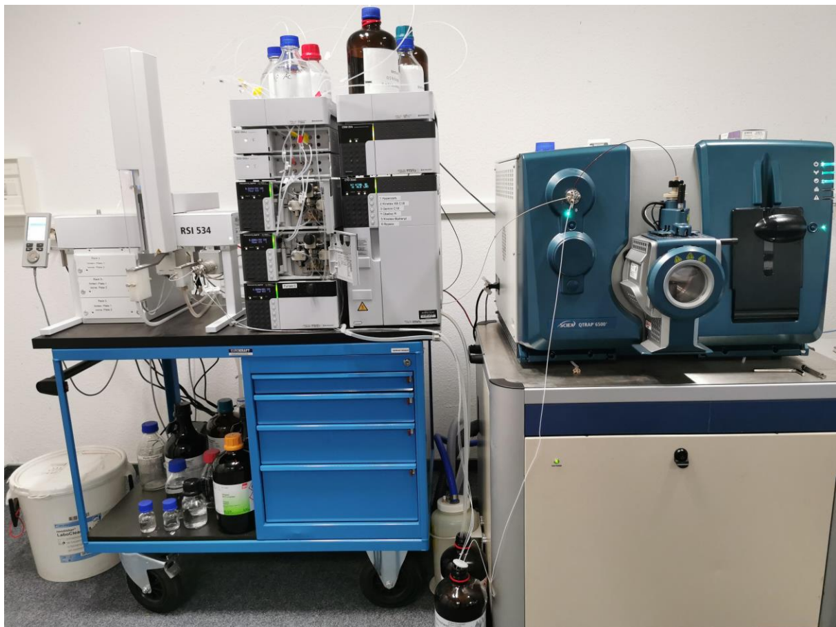
Abbildung 3. LC-MS/MS-System Sciex QTRAP 6500+
