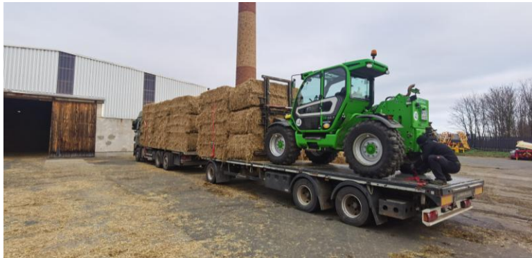
Abbildung 10 Transport Baustrohballen und Entladungstechnik, 2024, Quelle: Z-Arch.
