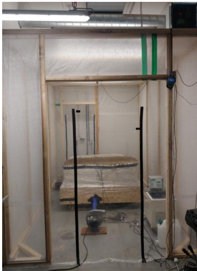
Abbildung 29 Konditionierung der Feuchte von Probekörper mit hygrisch konditionierter Raumluft, Kasten mit luftdurchlässigem Boden und angeflanschem Ventilator
