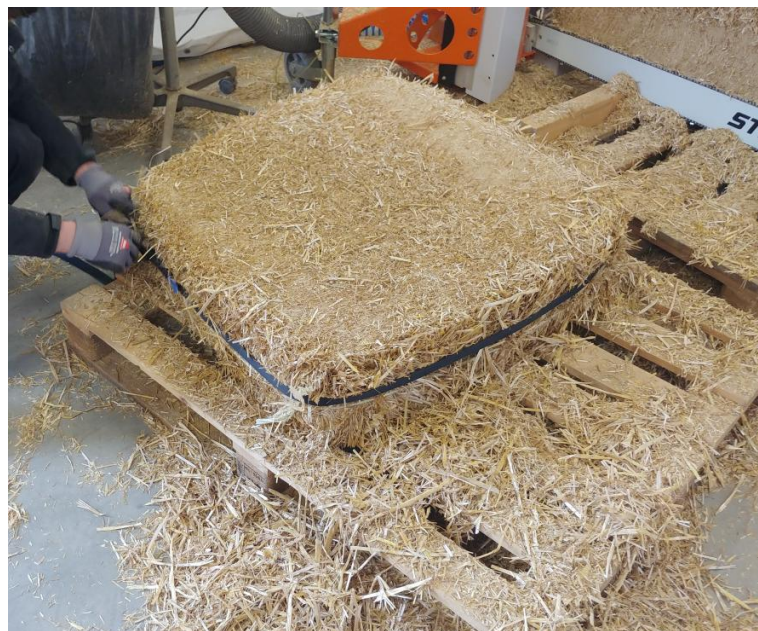
Abbildung 23 Sichern eines abgebundenen Ballens mit Spanngurten als Vorbereitung für die Messung im Plattengerät
