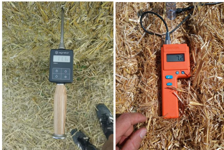
Abbildung 4 Feuchte-Messgeräte Agreto HFM II für Ernte 2024 (links) und Delmhorst F-2000 für Ernte 2022 (rechts), Quelle: Z-Arch.
