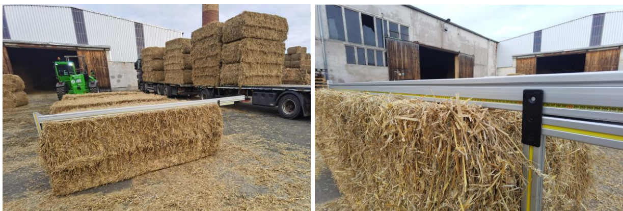
Abbildung 12 Längenermittlung mit Schiebelehre, 2024, Quelle: Z-Arch.
