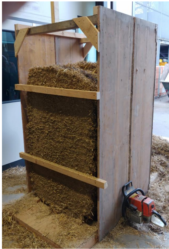
Abbildung 21 Schneiden eines Quaderballens mit einer Kettensäge, Fixierung des Ballens in einem Holzkastens
