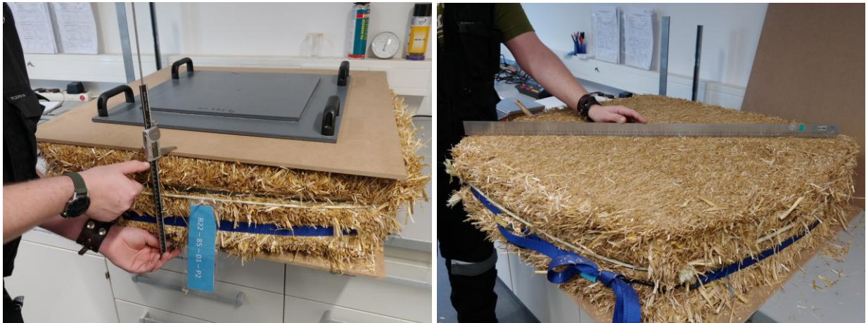
Abbildung 27 Dickenbestimmung der Strohballenprobe zwischen zwei Holzwerkstoffplatten (links), Demonstration der Ebenheit der Schnittoberfläche mit Stahllineal (rechts)
