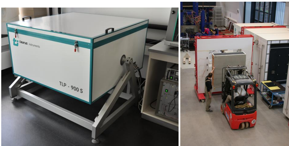
Abbildung 20 Prüfstände zur Bestimmung der Wärmeleitfähigkeit an großen Materialproben: Plattengerät (links) und Wandprüfstand mit typischem Probekörper (rechts)
