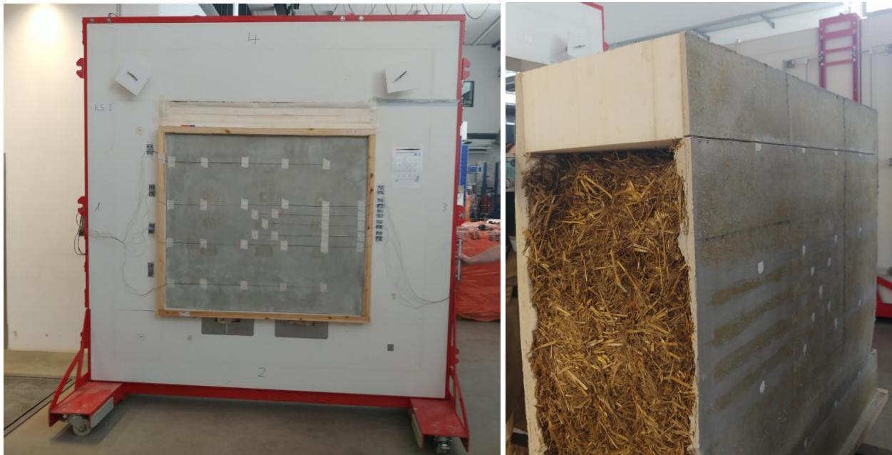
Abbildung 24 Messungen an einem verputzten Probekörper im Holzrahmen: Probekörper im Holzrahmen in der Prüfmaske eingebaut mit Temperatursensorbelegung (links), Probekörper nach den Ausbau aus dem Holzrahmen (rechts).
