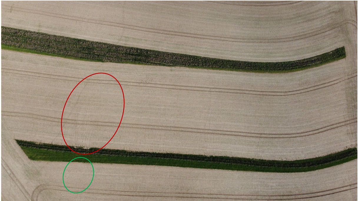
Abbildung 7: An Streifen C wurde ein Keyline-Retentionsgraben angelegt. Deutlich zu sehen ist, dass sich zwar auf dem darüber liegenden Ackerstreifen Oberflächenabfluss zu Rillen und Rinnen konzentrieren kann und Boden abträgt, dies jedoch vom Keyline-Retentionsstreifen gestoppt wird.
