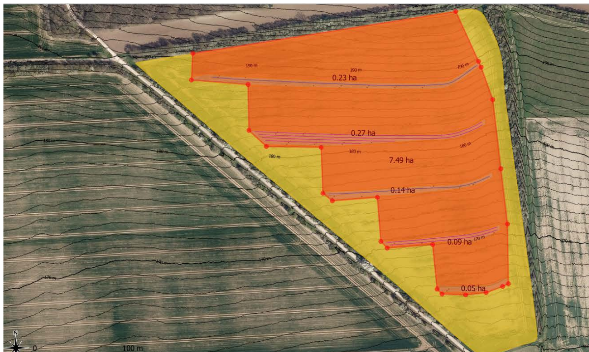
Abbildung 9: In Orange dargestellt ist die Fläche, deren Oberflächenabfluss in die Keyline-Strukturen fließt, dort verteilt und versickert wird. Lediglich die gelb dargestellten Flächen liefern aufgrund der Falllinie Abflüsse, die nicht in den Retentionsstreifen aufgefangen werden.
