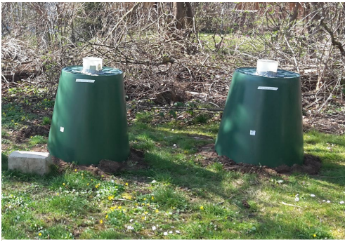
Abbildung 15 Photoelektoren zur Bonitur von aus dem Boden austretender, adulter Haselnussbohrer, Bild: Sandra Carnaghi
