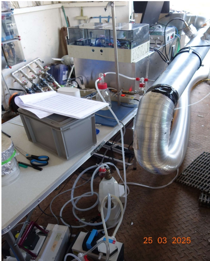
Abbildung 5.1.2: Peripherie und Messtechnik am Katalysatorsystem
