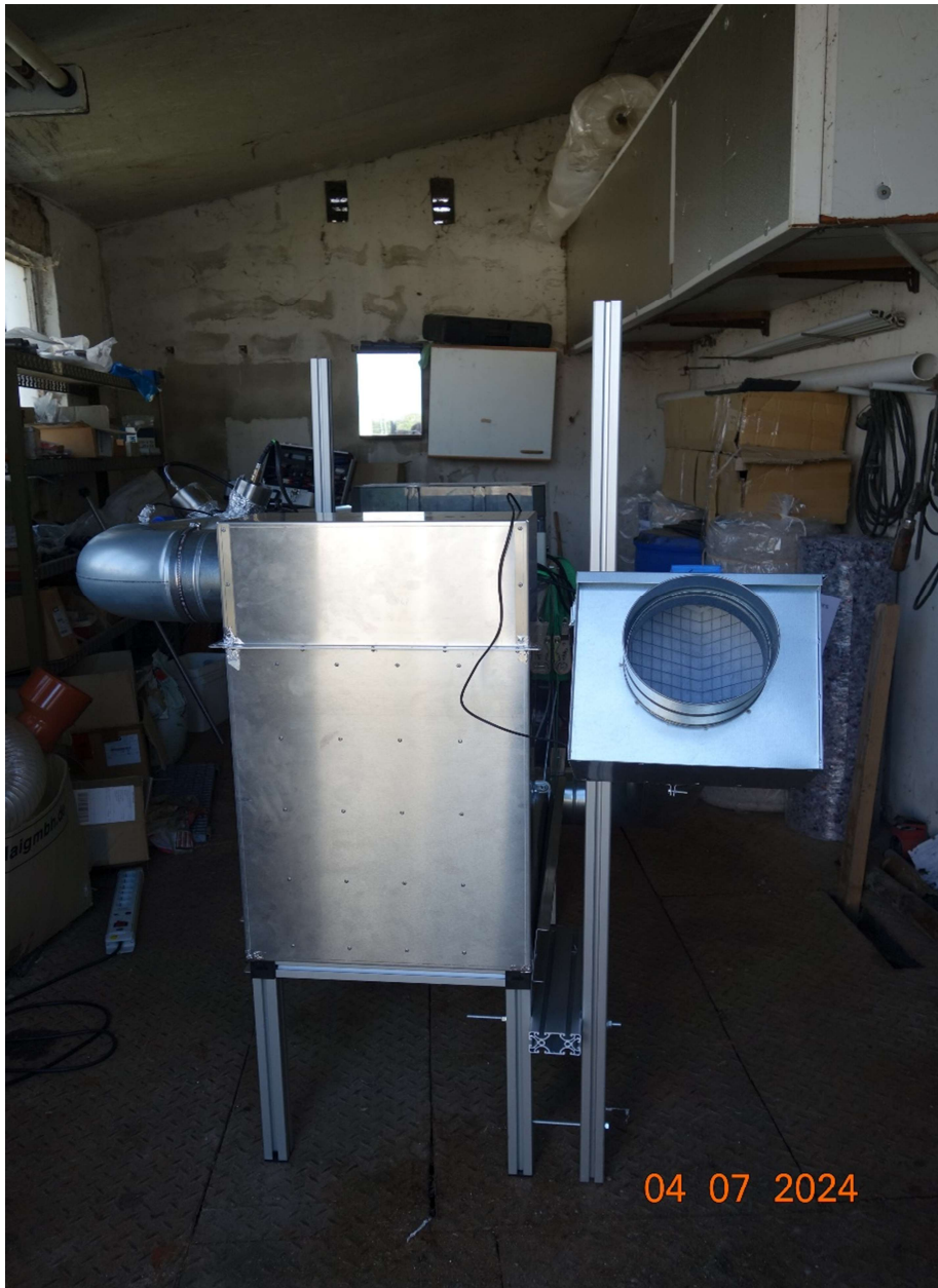
Abbildung 4.2.5: Vorfilter (rechts) mit Anschlußstutzen für Rohabluft- Schlauch
