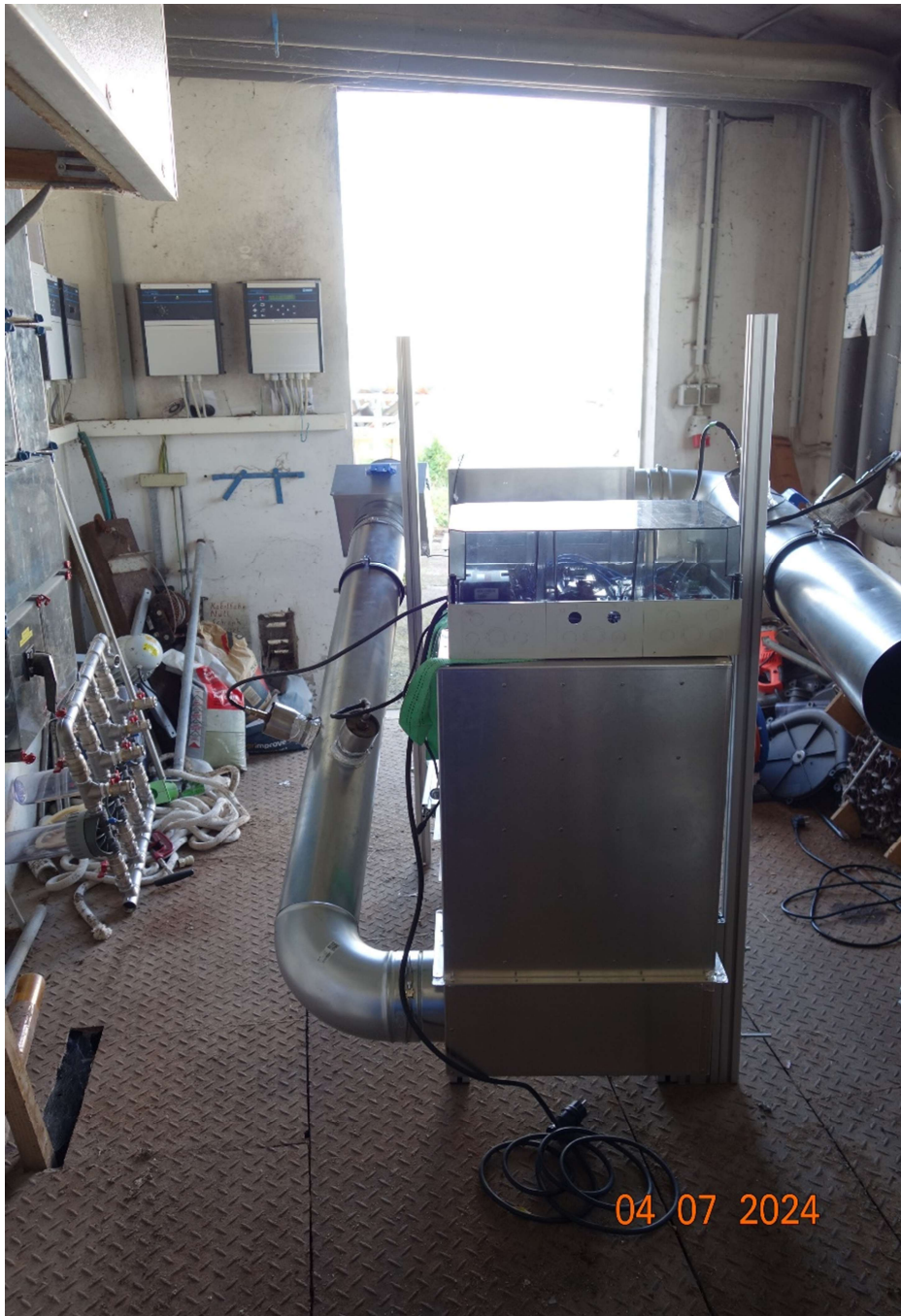
Abbildung 4.2.4: Photokatalyse- Reaktor mit Sensorik und Zuluftrohr (links)
