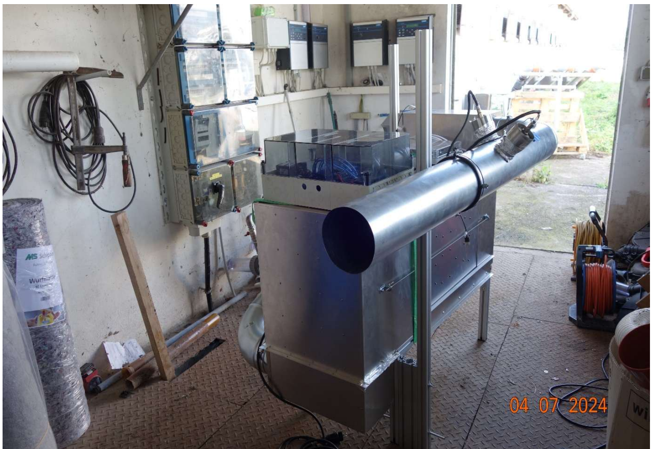
Abbildung 4.2.3: Photokatalyse- Reaktor mit Sensorik und Abluftrohr
