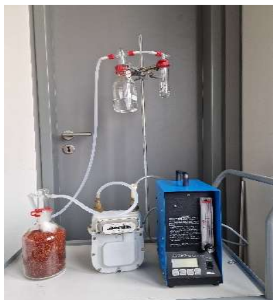
Abbildung 4.3.2 c: Versuchsaufbau zur Probenahme mittels Impinger
