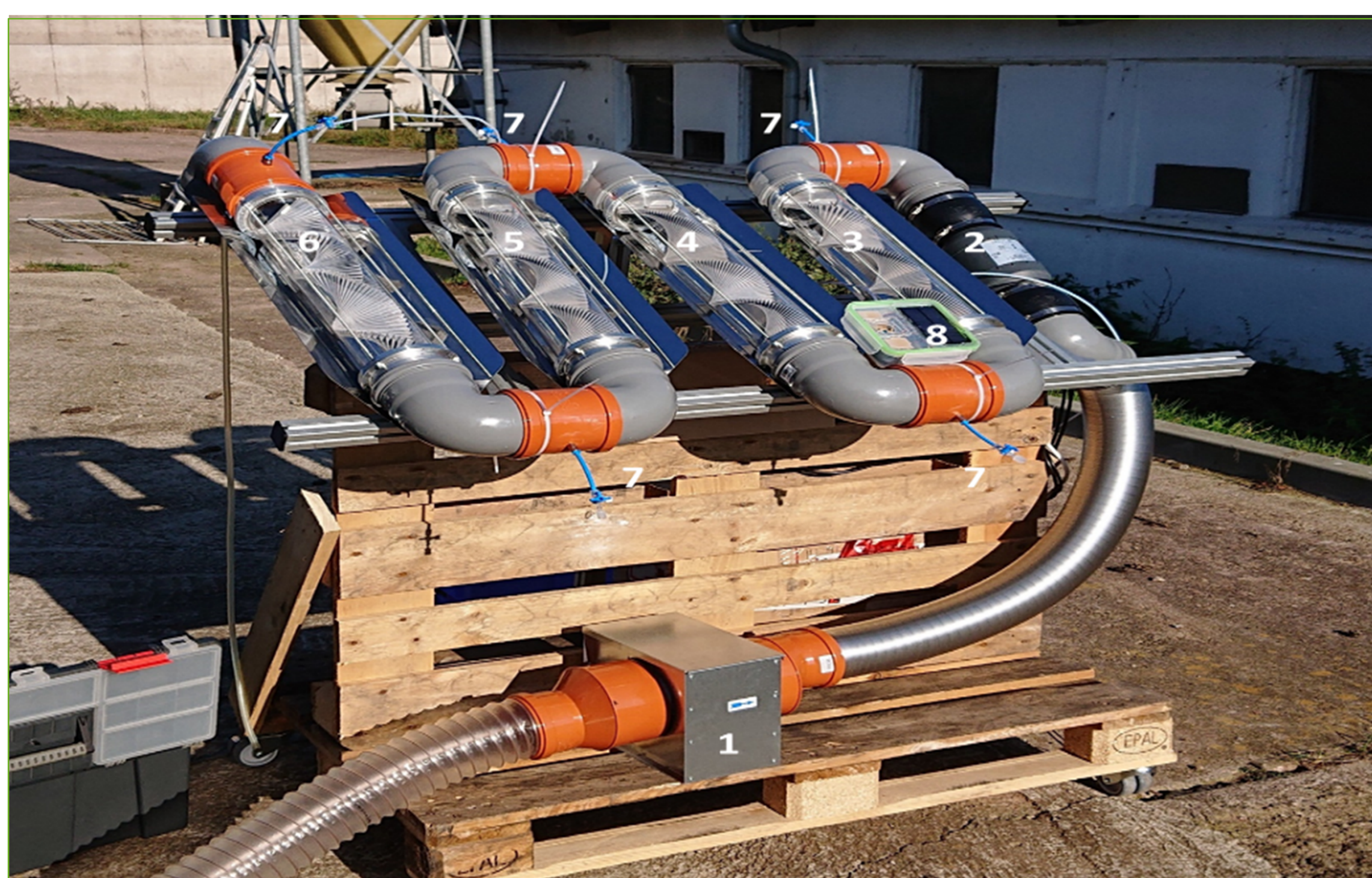
Kleintechnischer Demonstrator mit vier Helixreaktoren vor der Stallanlage in Reinholterode im solaren Betrieb
