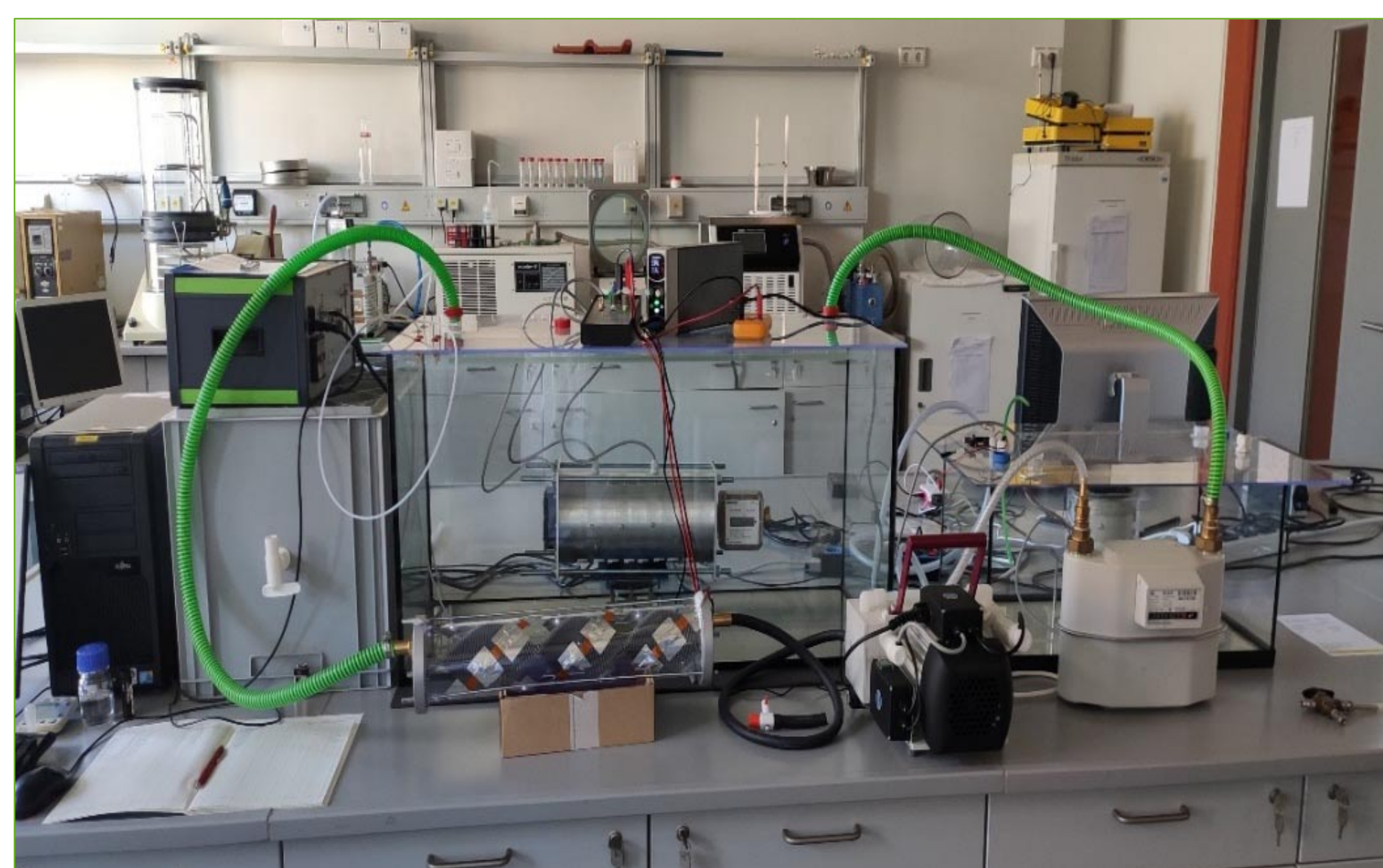
Abluftbehandlung mittels Helix- Reaktor im Labor, im Hintergrund: Rohrreaktor
