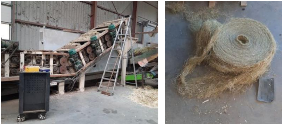
Abbildung 20 Prototypanlage Rollenaufschluss, Finalprodukt flächiges aufgewickeltes Faserband
