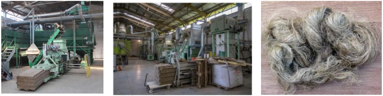
Abbildung 17 Aufschlussanlage und aufgeschlossene, feldgeröstete Hanffasern
