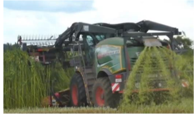
Abbildung 18 Spezialerntemaschine für Feldentholz von frisch-grünem Hanf
