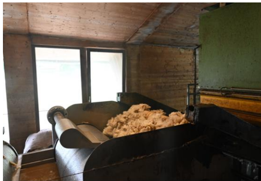
Abbildung 5 Zuführung der geöffneten Rohwolle in die Waschanlage
