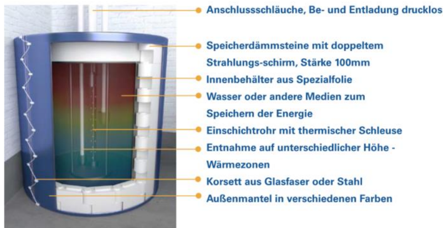
Abbildung 12 Aufbau Wärmespeicher
