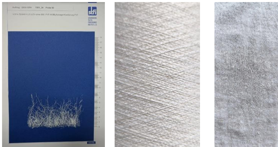
Abbildung 26 – Faserprobe B9930 / OE-Garn 70/30 CLY/HA B9930 48 tex [Nm 21] / Kleinrundstricktest E26
