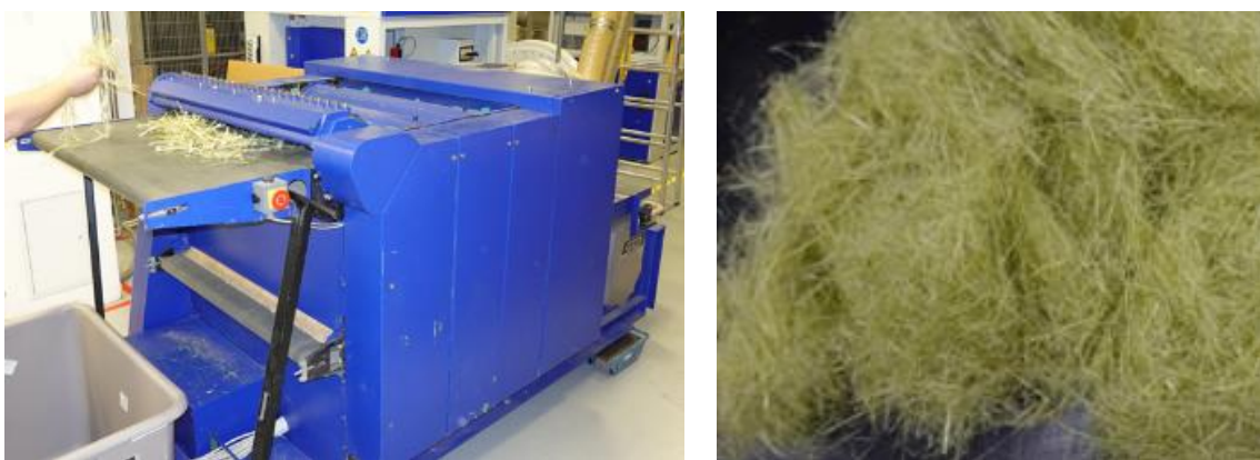
Abbildung 16 Walzenreinigungsmaschine und gereinigte, eingekürzte Hanffasern
