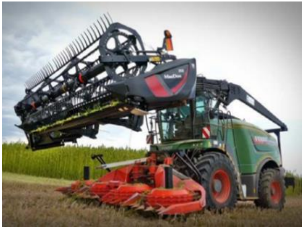
Abbildung 18 Spezialerntemaschine für Feldentholz von frisch-grünem Hanf
