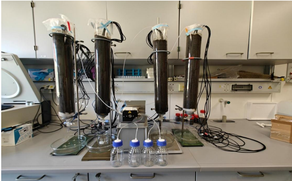
Abbildung 9: Perkolatorversuche im Labormaßstab mit Versuchssperipherie (Bewässerung, Sensorik)
