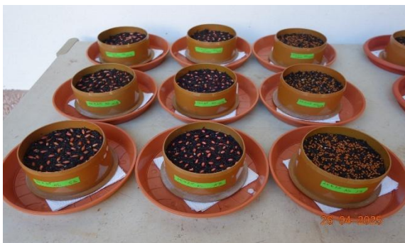
Pflanzenverträglichkeitstest von Gärrest ( undotiert ) Pflanzsubstratgemisch mit 5, 10 bzw. 20% Gärrestanteil: Kontrollansatz: Gerste (links), Weizen (Mitte), Kresse (rechts)
