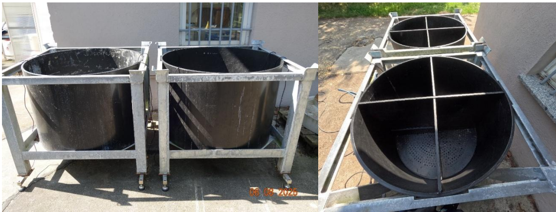
Abbildung 10: Versuchsaufbau Lysimeterprüfstand im kleintechnischen Maßstab
