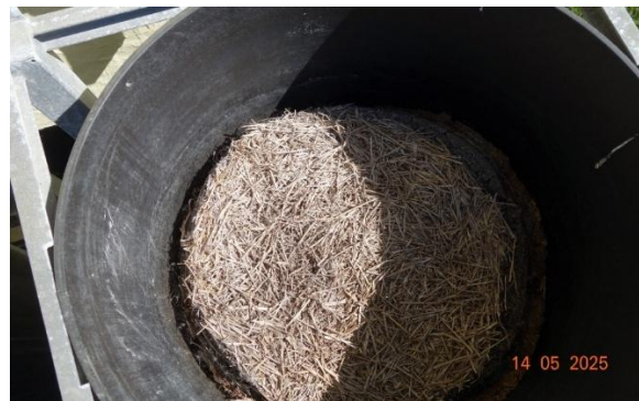
Halbtechnische Anlage zur Gärrestvererdung bzw. -verstrohung nach Befüllung mit Zuschlägen nach 10 Monaten
