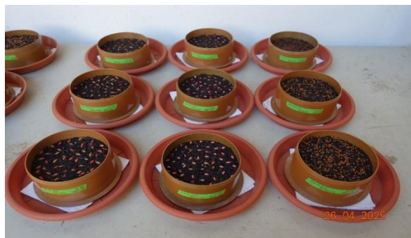
Pflanzenverträglichkeitstest von Gärrest ( dotiert ) Pflanzsubstratgemisch mit 5, 10 bzw. 20% Gärrestanteil: Prüfansatz mit Fluorchinolon-Dotierung: Gerste (links), Weizen(Mitte), Kresse (rechts)
