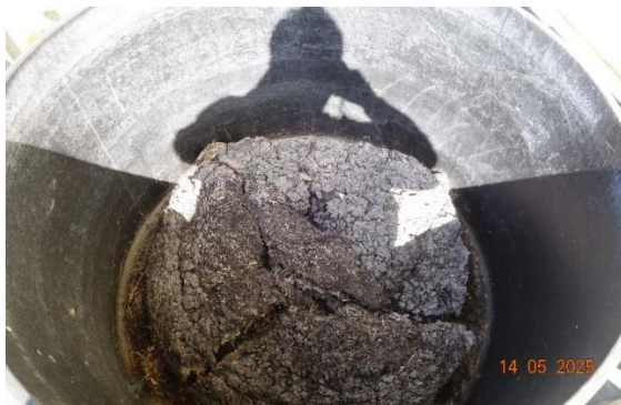
Halbtechnische Anlage zur Gärrestvererdung bzw. -verstrohung nach Befüllung ohne Zuschläge nach 10 Monaten
