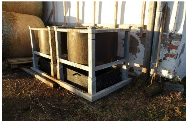
Abbildung 4: Halbtechnische Anlage zur Gärrestvererdung bzw. -verstrohung
