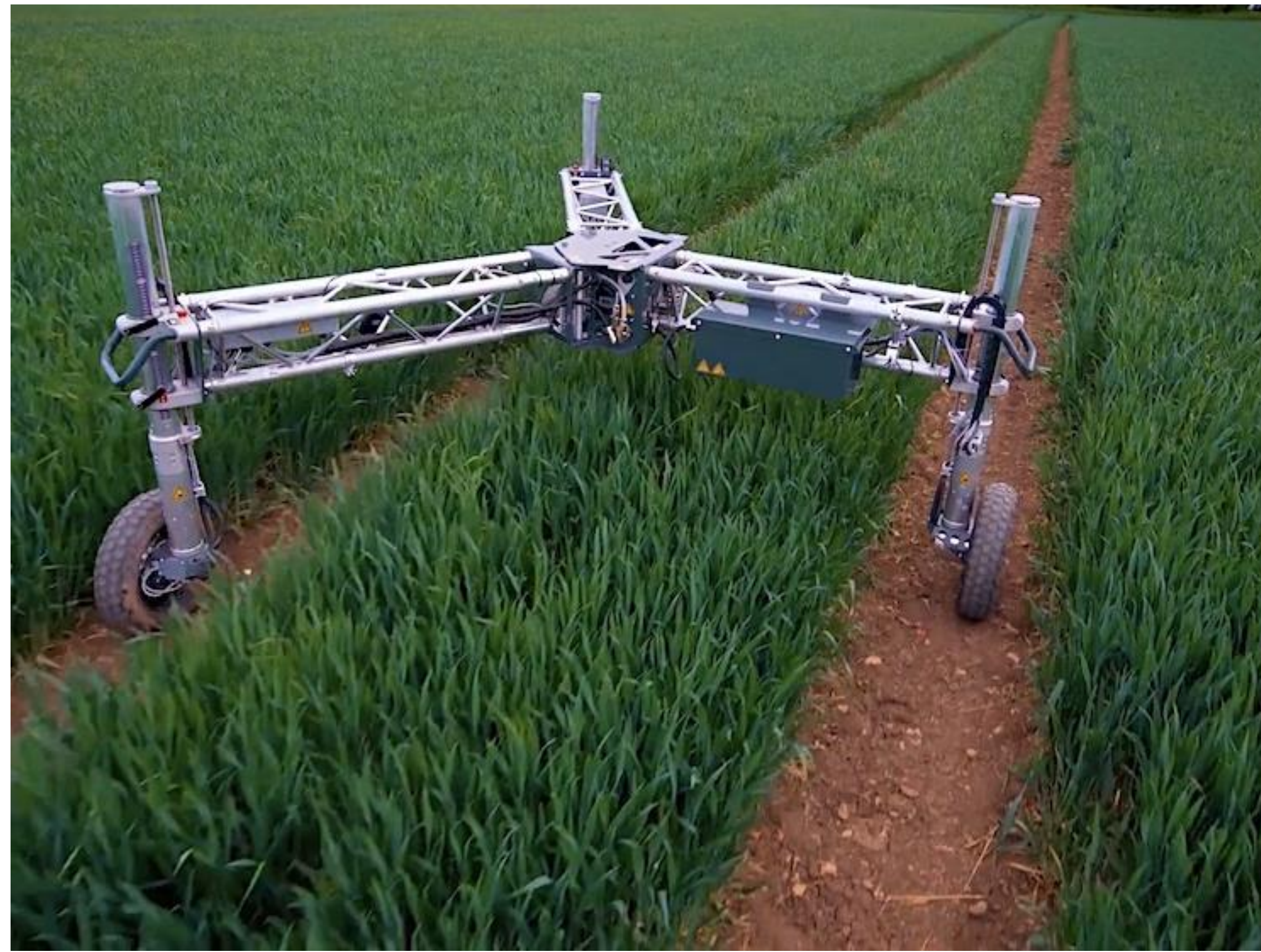
Abbildung (© E-TERRY): Der leichtgewichtige E-TERRY mit anpassbarer Spurbreite und Höhe im Feld
