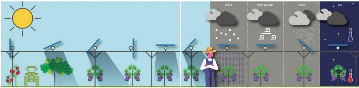
Abbildung 8 Mögliche Schutzwirkungen der Module für die Kulturen durch verschiedene Ausrichtungswinkel bei Tracking-Systemen (Vandest und Hemetsberger 2021)
