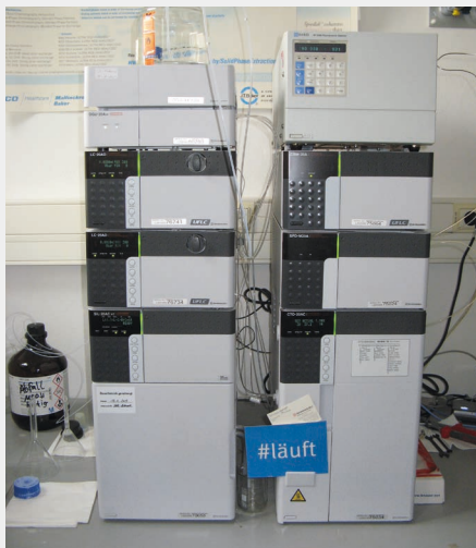
Abbildung: Der farblose Zuckersirup wird bis zur Analyse im Kühlschrank aufbewahrt. Die Probe wird in Vorbereitung auf die Analyse eingewogen. Der Gehalt an HMF wird mit der HPLC-UV bestimmt.
