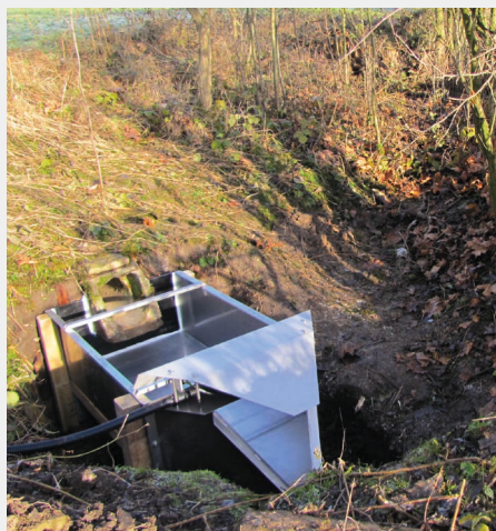
Dränabflussmessgerät am Dränmessfeld Dielsdorf (roter Punkt) Foto: S. Knoblauch
