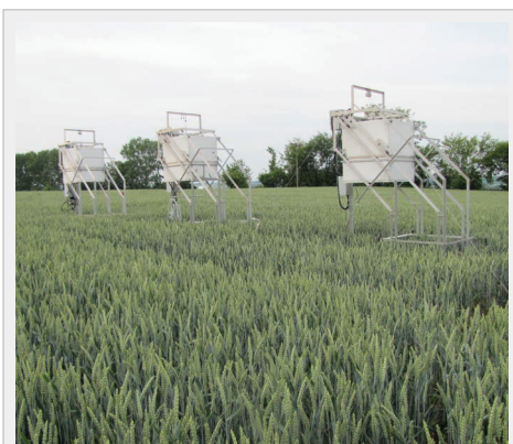
Lachgasmesssystem in der Zweigstelle Butteltstedt im Thüringer Becken Foto: S. Knoblauch
