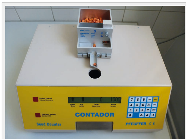
Automatisches Zählen von je 1000 Samen für das Subsampling bei der GVO-Saatgutuntersuchung
