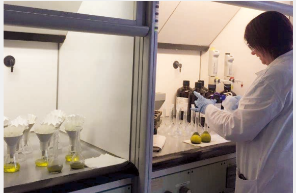
Königswasseraufschluss für Boden, Klärschlamm und Bioabfall Foto: K. Engler
