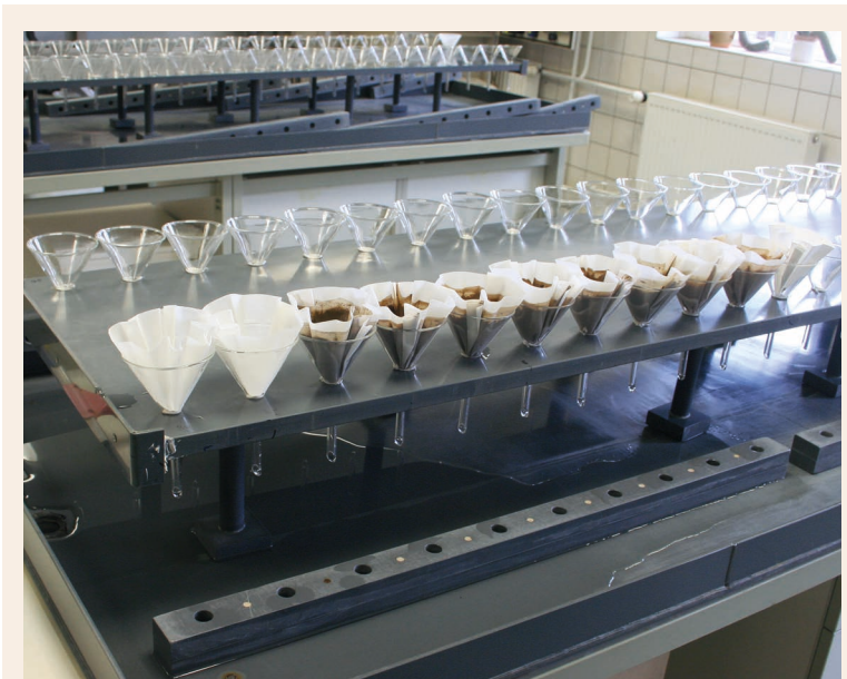
Herstellung von Bodenextrakten Foto: G. Kießling
