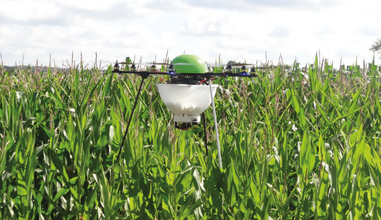
Ausbringen von Trichogramma-Schlupfwespen mittels Drohne eröffnen den Landwirten neue Möglichkeiten für eine schlagkräftige, umweltschonende und wirksame Bekämpfung des Maiszünslers Foto: K. Weidemann
