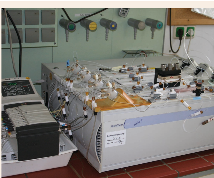
Bestimmung von Phosphor mittels Fließinjektionsanalyse Foto: G. Kießling
