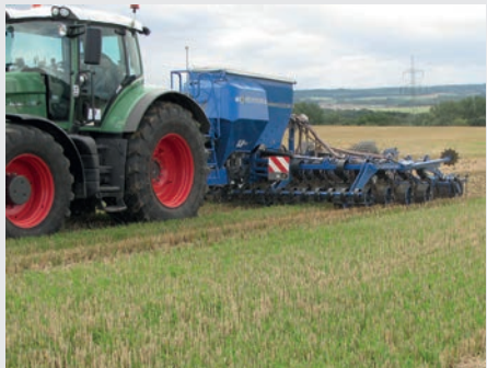
Abbildung 1: Direktsaat mit der Grubberdrillmaschine Köckerling Ultima CS und der Strip-Tillage-Drillmaschine Claydon Hybrid T
