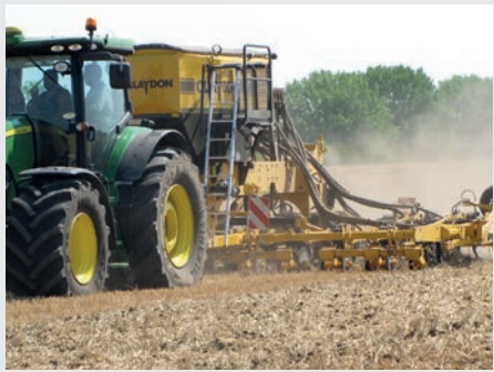
Abbildung 1: Direktsaat mit der Grubberdrillmaschine Köckerling Ultima CS und der Strip-Tillage-Drillmaschine Claydon Hybrid T
