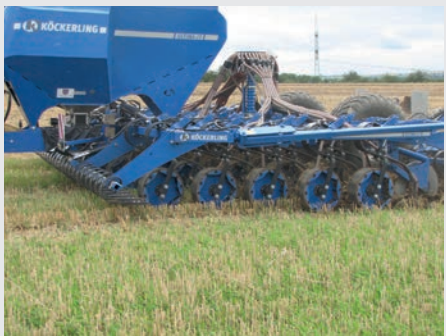
Abbildung 1: Direktsaat mit der Grubberdrillmaschine Köckerling Ultima CS und der Strip-Tillage-Drillmaschine Claydon Hybrid T
