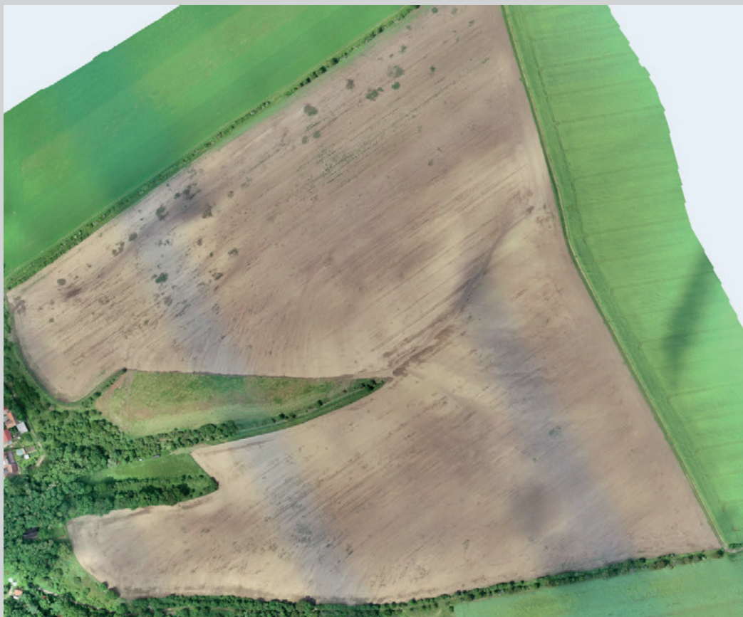
Abbildung 3: UAV-basiertes Orthofoto einer Hotspotfläche zur Identifizierung von Fließwegen und Schadensausmaß in Mittelthüringen.
