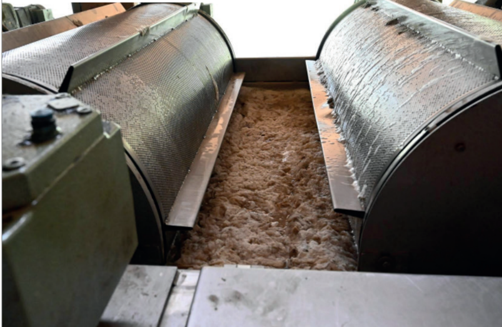
Bäder einer Wollwaschanlage mit Wollwaschabwasser (Foto: Chr. Baur)
