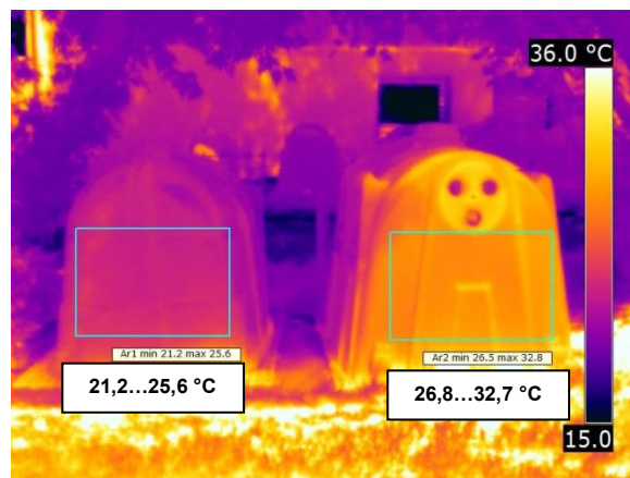
Abbildung 8: Wärmebild von Iglus in der Sonne und im Schatten
