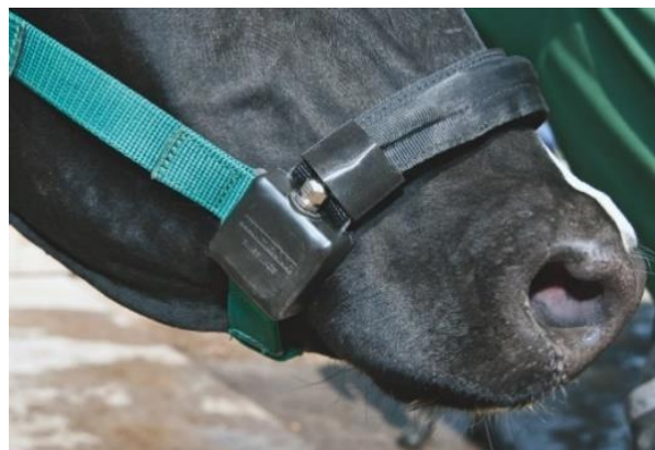
Abbildung 2: Sitz des Druckschlauchs auf der Nase bei angelegtem RW-Messhalfter (Quelle: ITNIN+HOCH)
