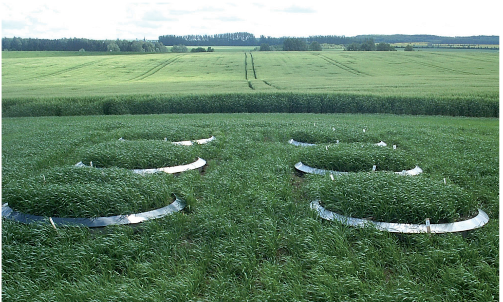
Lysimeteranlage inmitten eines Feldes
