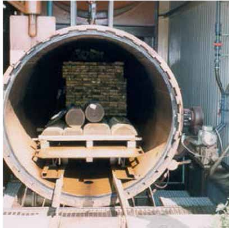
Trogtränk- und Kesseldruckimprägnieranlage für GK 3 und GK 4
