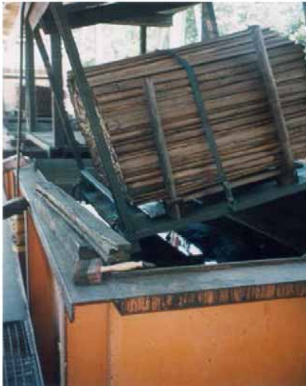
Trogtränk- und Kesseldruckimprägnieranlage für GK 3 und GK 4
