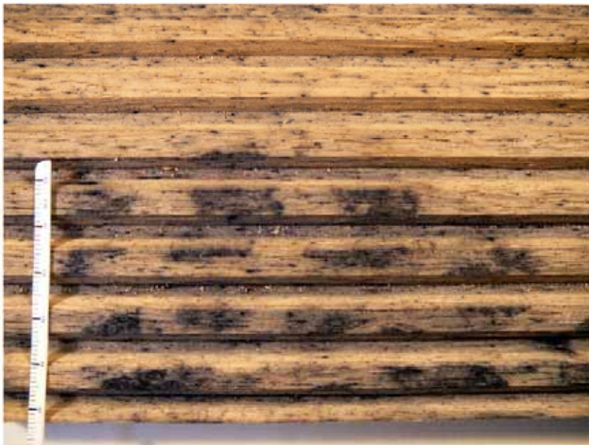
Eiche; Eisenpartikel führen zu Verfärbungen; M 10:1
