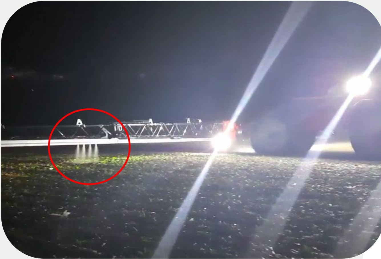
Spot-Spray Applikation in Zuckerrüben mit HORSCH Leeb-PT und pulsweitenmodulierter Düsenschialtung
