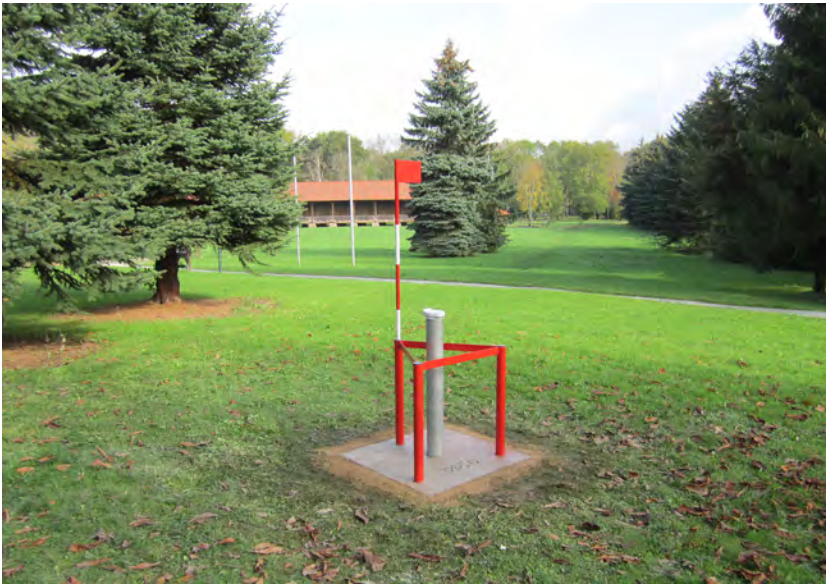
Abbildung 32: Grundwassermessstelle in Bad Sulza mit Anfahrtsschutz und Sichtstange (Quelle: ThLG)
