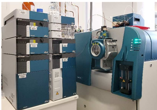
Hochauflösendes Massenspektrometer für die organische Rückstandsanalytik
